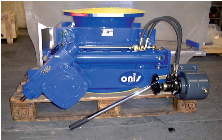
Obturador 16" PN 10 com deslocamento hidráulico do obturador
