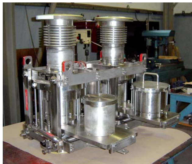
Equipamento ONIS de 6" # 150 com sistemas de discos de ruptura e compensadores SANOFI SYNTHELABO - França
