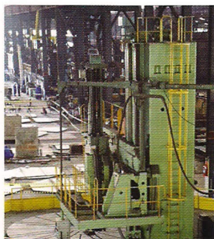
Torno vertical de 160 toneladas de capacidade e placa de 6,3m, diâmetros de até 12m e 5m de altura
