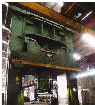
Prensa hidráulica com capacidade de 6.000 toneladas e 4,5m de altura
