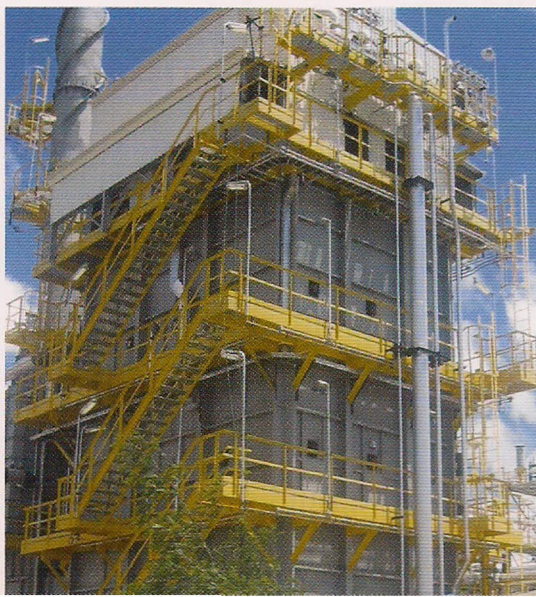
◀ Forno Reformador da REPAR, um dos principais equipamentos de processos da unidade que a Confab Equipamentos entregou à Petrobras
